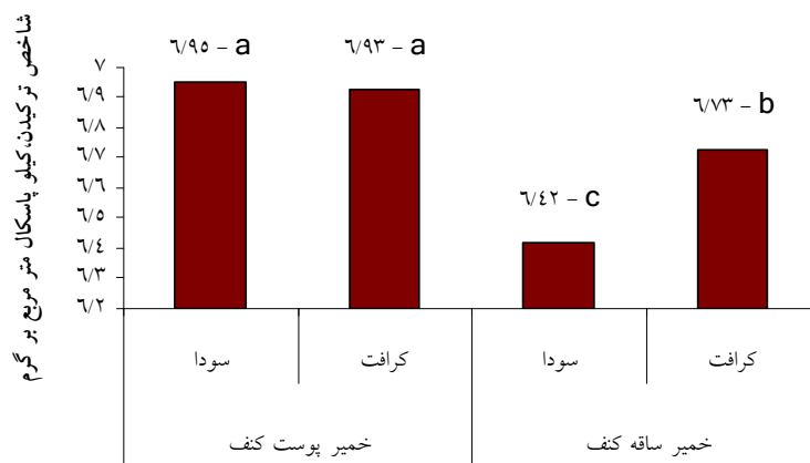
شکل ۵. شاخص ترکیدن کاغذهای حاصل از خمیر کاغذهای کرافت و سودای پوست و ساقه کنف (حروف مشابه در هر ستون بیانگر عدم اختلاف معنی دار بر مبنای آزمون دانکن در سطح ۱ درصد است)
