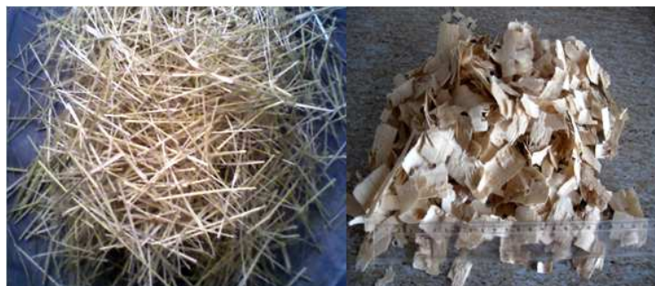
شکل ۱. ساقه برنج (سمت راست) و تراشه چوب صنوبر (سمت چپ) بعد از خروج مواد استخراجی
