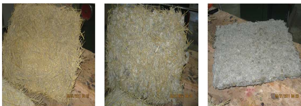
شکل ۲. نمونه تخته چوب‌سیمان (سمت راست)، نمونه تخته چوب و ساقه برنج‌سیمان (وسط)، نمونه ساقه برنج‌سیمان (چپ)
